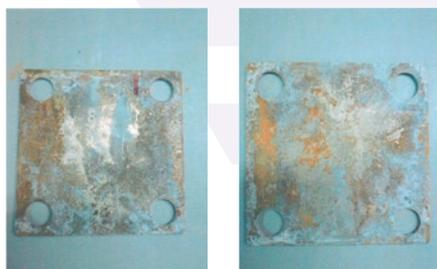
а) пластинки с гальваническим цинковым покрытием
