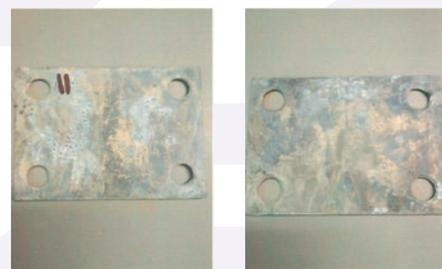
а) пластинки с горячеоцинкованным цинковым покрытием
