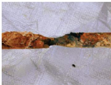
Штырь заземления с цинковым покрытием толщиной 99 мкм, извлеченный из грунта (суглинок) после 10 лет
