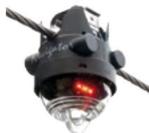
Индикатор хранит в памяти информацию о токе нагрузке линии за последние 72 часа, что позволяет ему устанавливать порог срабатывания автоматически, что в свою очередь делает его удобным инструментом в сетях с низкой нагрузкой.
