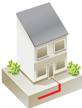
Электролитическое заземление предназначено для использования в вечномёрзлых, каменистых или песчаных грунтах, имеющих высокое удельное сопротивление (от 300-500 Ом\*м), без применения специальной техники и насыпного грунта.
