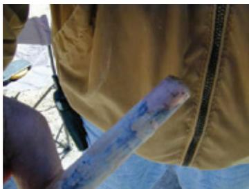
Штырь заземления с медным покрытием толщиной 254 мкм, извлеченный из грунта (суглинок) после 10 лет
