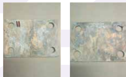
а) пластинки с горячеоцинкованным цинковым покрытием
