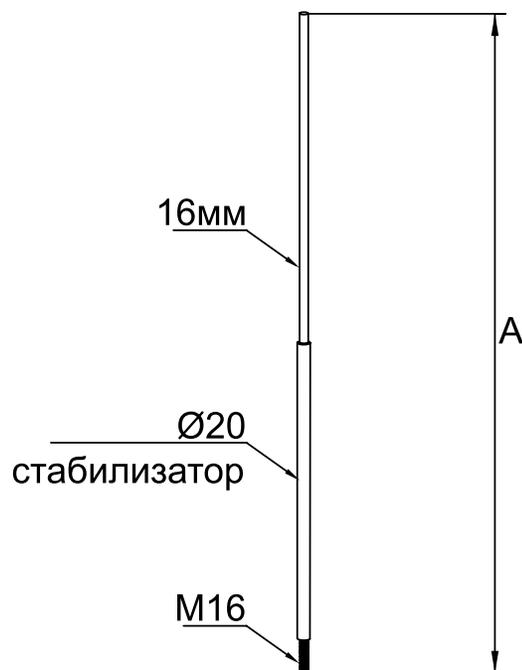
Осуществляет непосредственный прием разряда молнии и передает его по токоотводу на заземлитель. Предназначен для установки совместно с бетонными, металлическими основаниями, либо для крепления держателями к вертикальным элементам зданий.
